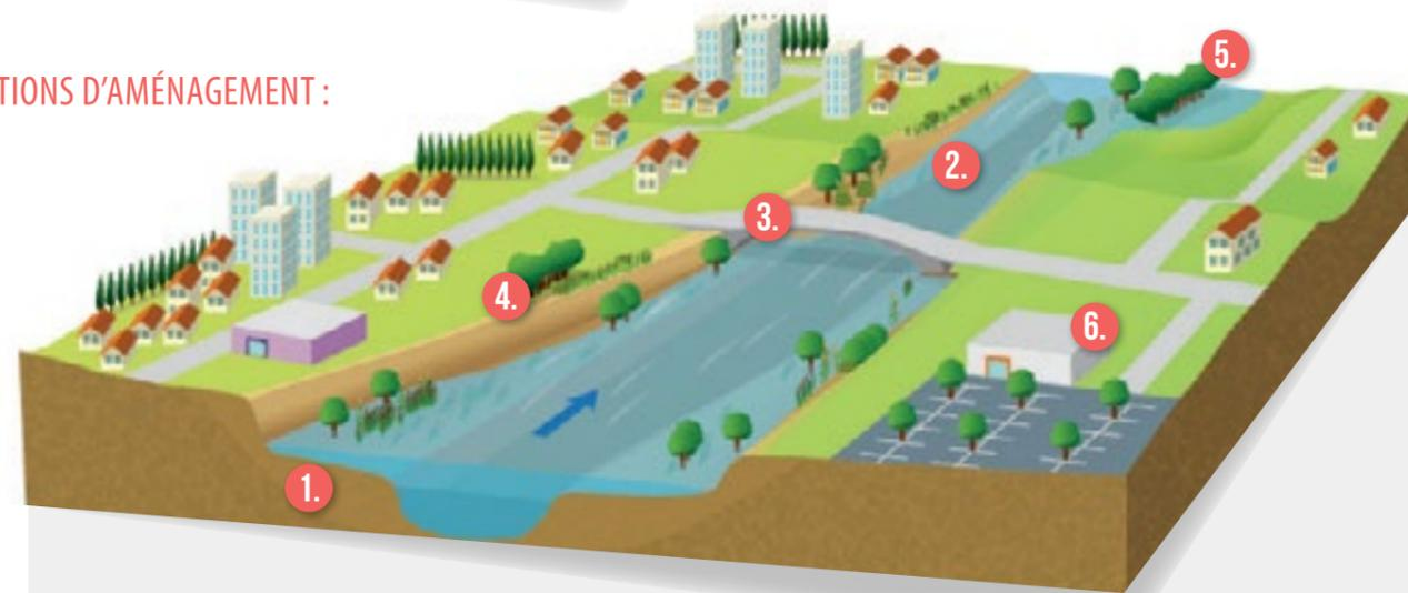
1. Rétablissement de la capacité hydraulique du lit mineur et du lit moyen (remodelage des berges sous forme de terrasses submersibles) pour favoriser le transit des crues les plus fréquentes.
